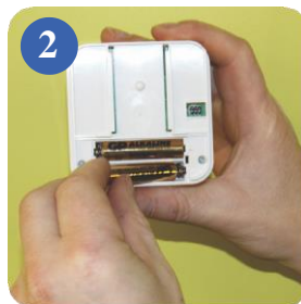
2 Do jednotky iT300 vložte 2 priložené batérie AAA.
