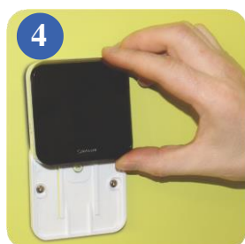
4 Nasad'te držiaky na zadnej strane iT300 na „kofajničky“ na držiaku a nasuňte jednotku na držiak.
