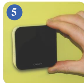
5 Po nasutí skontrolujte, či jednotka pevne drží.
